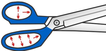
Herkömmliche Scheren haben mehr Druckstellen und erfordern Kraft zum Öffnen und Schließen.
