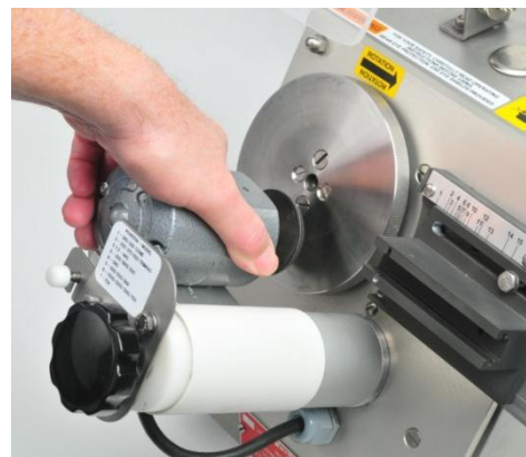
Tournez le moteur dans le sens inverse des aiguilles d'une montre.
