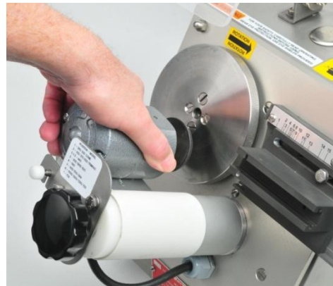
Drehen des Motors gegen den Uhrzeigersinn.
