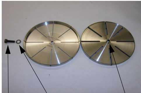
Klingenhalter-Schraube Unterlegscheibe Führungsnahe auf der Rückseite des Klingenhalters
