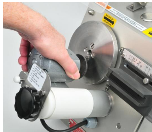
Haga girar el motor en sentido antihorario.
