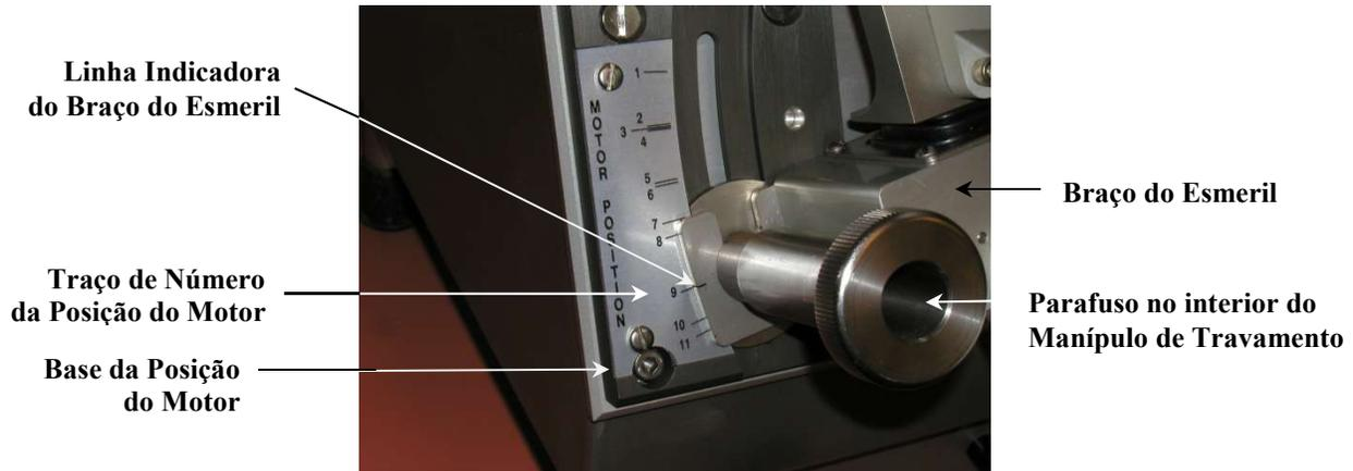
O manípulo de travamento pode ser afrouxado para inclinar o braço do esmeril para baixo, afastando-o do trajeto ao fazer a troca de lâminas, sem perder a posição de regulagem do motor. Incline o braço do esmeril de volta para cima contra a coluna do manípulo de travamento e aperte o manípulo de travamento para reposicionar o braço do esmeril na posição de esmerilhamento.
