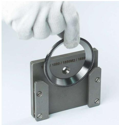
Lâminas que passam através do calibrador precisam ser descartadas.
