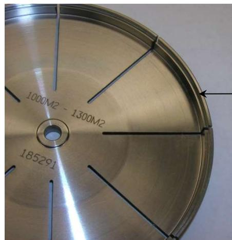
Rebaixo do Alojamento da Lâmina para a Lâmina
