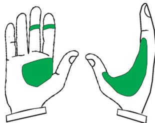
Avec AirShirz la surface de contact accrue répartit la force sur une zone plus étendue, ce qui est plus confortable pour l'opérateur.
