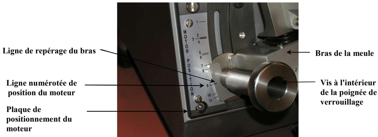
La poignée de verrouillage peut être desserrée pour faire écarter le bras de la meule vers le bas lors des changements de lames, sans perdre la position de réglage du moteur.
