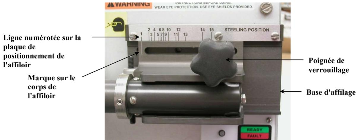
L'affiloir est maintenu en position basse par un plongeur à ressort. L'affiloir peut être pivoté vers l'extérieur du support en tirant la poignée de rotation.
