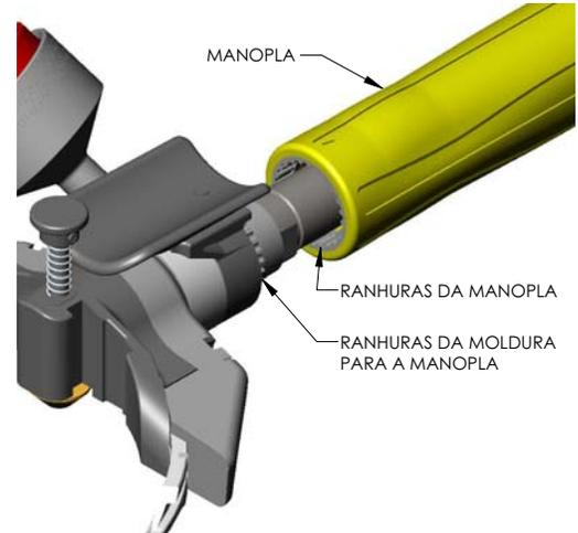
**NOTA:** A manopla pode ser ajustada para se adequar ao operador e à estação de trabalho empurrando a manopla para trás para retirá-la da estrutura e recolocando-o para outro conjunto de nós do tubo da estrutura.
