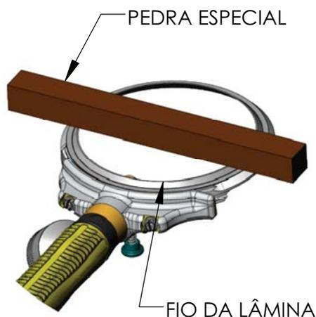
Use o amolador especial Whizard<sup>®</sup> para terminar o afiamento da lâmina. *Consultar a seção 4, Afiamento da lâmina.*
