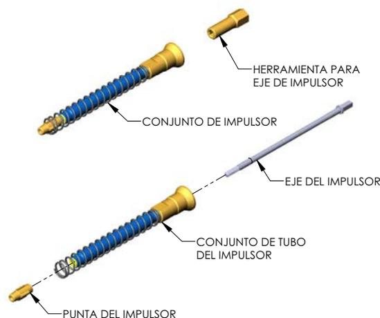
**NOTA: Los modelos de herramientas grandes:** X750, X850, X1000, X1300, X1400, X1500, X1850, X1880 utilizan una punta de impulsor grande.
