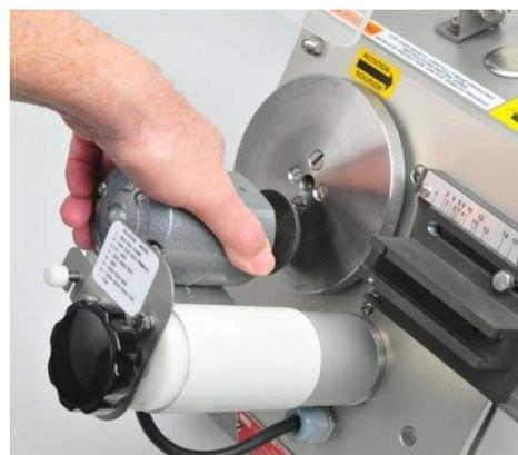
Ruotare il motorino in senso antiorario.
