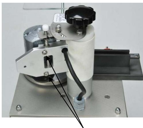
Viti di montaggio del motorino
