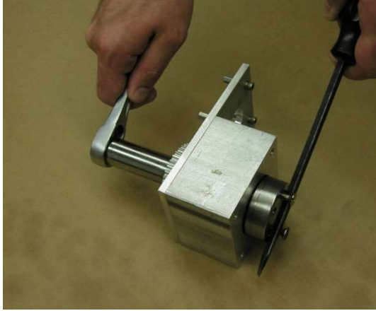
Entfernen der Sicherungsmutter
