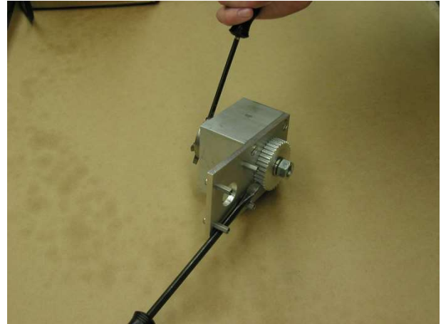
Rimozione della puleggia
