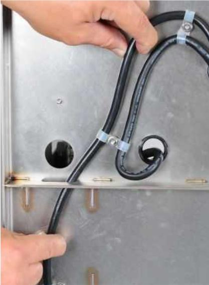
**Étape 10 :** Installez de nouveau les écrous, les rondelles et les colliers sous le châssis.
