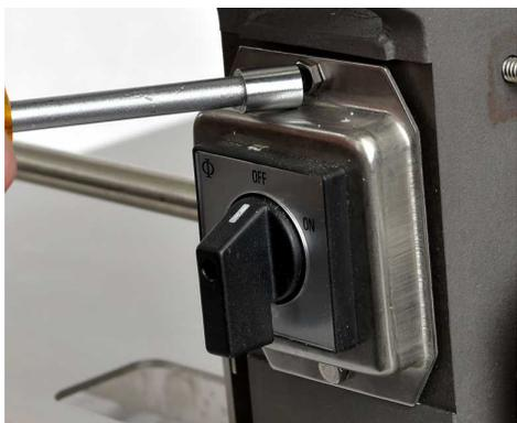
**Étape 3: (pour les machines en 115 V):** Tirez l'interrupteur d'alimentation pour le sortir de son logement, et débranchez les deux fils noirs de son arrière en desserrant leurs vis de retenue.
