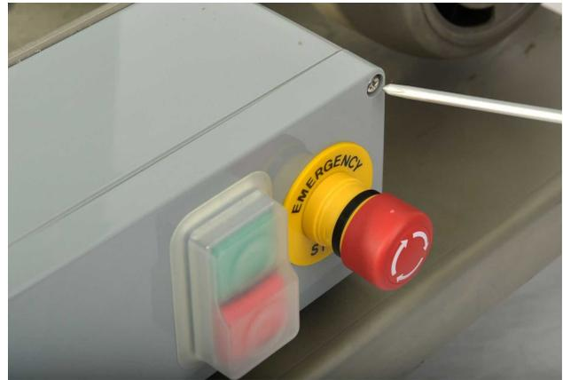
**Étape 9:** Réinstallez les couvercles de protection d'entraînement, les boutons et les loquets de verrouillage.
