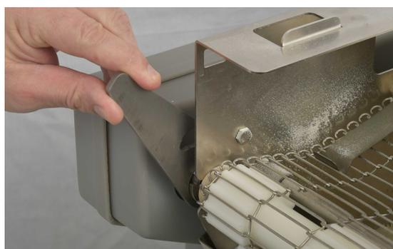
**Étape 8:** Soutenez le e convoyeur à panure à l'avant avec la main gauche sur le pignon et la main droite à l'arrière. (Placez le pouce dans la poignée avec les doigts soutenant le plateau inférieur.) Retirer.
