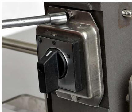
**Étape 3: (POUR LES MACHINES EN 115 V) :** Tirez l'interrupteur d'alimentation pour le sortir de son logement, et débranchez les deux fils noirs de son arrière en desserrant leurs vis de retenue.
