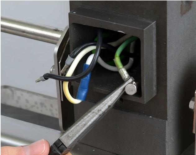
**Étape 5: (POUR LES MACHINES EN 115 V):** Le fil de Neutre (blanc) du cordon d'alimentation est raccordé au fil (blanc) du cordon de moteur. Supprimez cette jonction en coupant ces fils blancs de chaque côté au ras de leur jonction. Dénudez l'extrémité du fil blanc du cordon de moteur.
