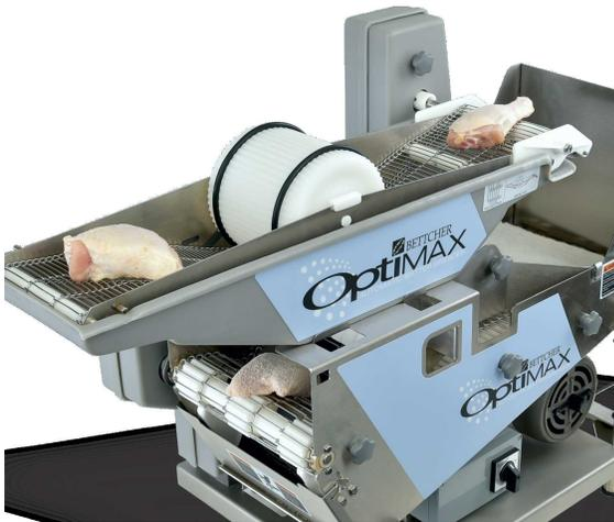
**Étape 3 :** Le produit est revêtu de panure lorsqu'il passe entre les parois de resserrement et sous l'assemblage des palettes. Le produit sort à l'extrémité avant de l'applicateur de panure.
