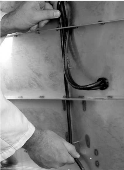
**Étape 10:** Remettez en place écrous, rondelles et serre-câbles sous le châssis.
