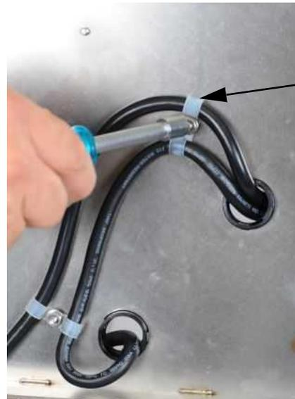
**Étape 11 :** Installez le fil de terre vert à l'arrière de la boîte de distribution à l'aide d'un tournevis à douille 5/16 po.
