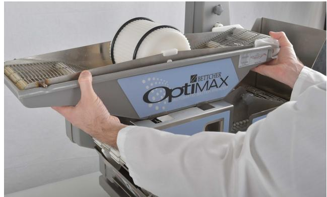
**Étape 12:** Alignez l'arbre entraîné du convoyeur avec le manchon de guidage du palier sur l'assemblage du châssis.
