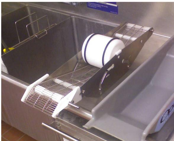
**Étape 7 :** Lorsque les composants sont secs, installez l'assemblage du convoyeur de pâte à frire dans le réservoir.
