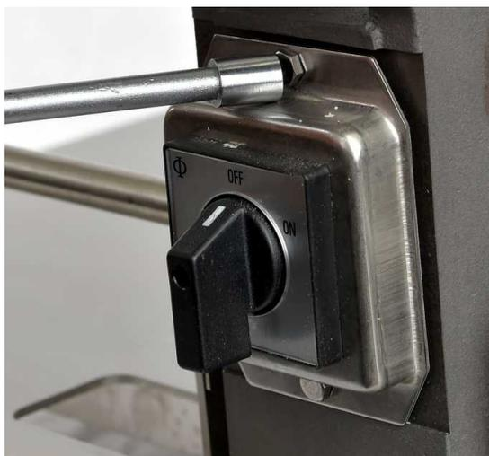
**Étape 11:** Réinstallez les couvercles de protection d'entraînement, les boutons et les loquets de verrouillage.
