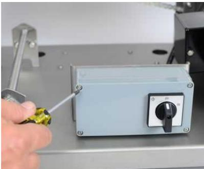
**Étape 3 :** Retirez l'interrupteur du boîtier et déconnectez les fils derrière l'interrupteur en desserrant les vis de fixation.
