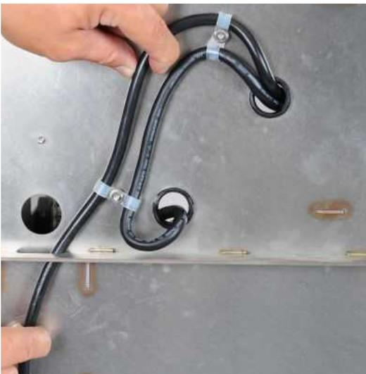
**Étape 9:** Remettez en place écrous, rondelles et serre-câbles sous le châssis.
