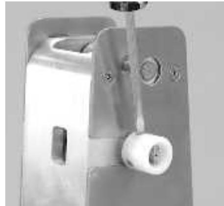
**Étape 13 :** Réglez la tension de la chaîne de transmission en laissant le poids du moteur tendre la chaîne. Pour ne pas trop tendre la chaîne de transmission, assurez-vous de lui laisser 3/4 po de jeu tel qu'illustré. Serrez les 4 boulons de montage du moteur.
