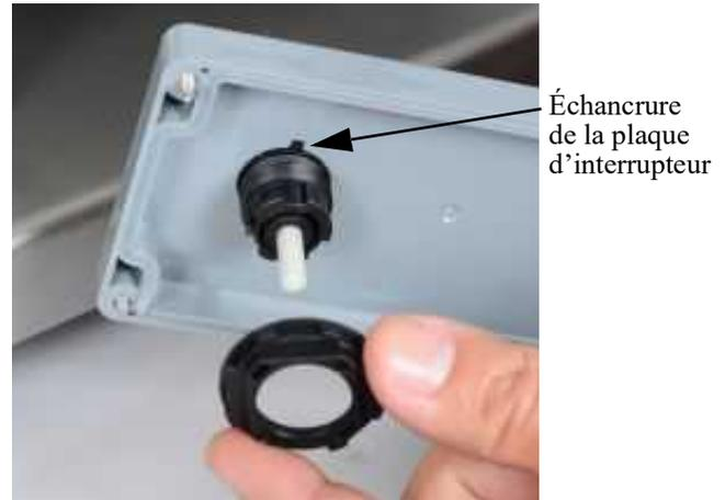
**Étape 7 :** Installez la bague de retenue et serrez le tout.
