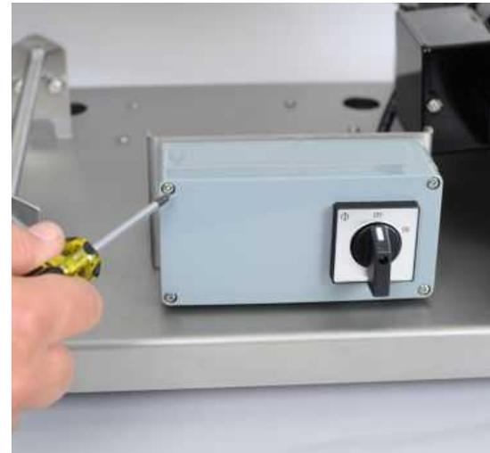
**Étape 11 :** Installez les couvercles protecteurs du moteur, les boutons et les languettes de verrouillage.
