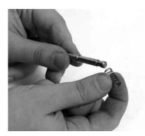
Glissez la tige de fusil ID au travers du positionneur et dans le support de tiges. Serrez la vis de tige de fusil ID.
