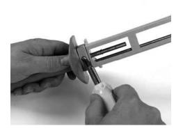
Glissez le fusil ID dans la tige de fusil ID. Glissez un ressort sur la tige de fusil ID. Installez et serrez la vis de fusil ID.
