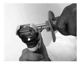
• Tout en maintenant le positionneur de l'aiguisoir Bettcher® E-Z EDGE sur le logement de la lame du couteau, poussez la tige d'affûtage vers la lame du couteau. Maintenez la tige d'affûtage contre le bord externe de la lame pendant quelques secondes, en appliquant une très légère pression. Cela va affûter le bord externe de la lame.
