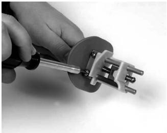
• Le positionneur et le fusil ID doivent bouger librement sur leurs tiges.
