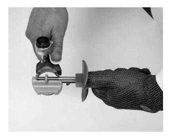
Remarque : Le mouvement vers l'avant et vers l'arrière ne doit être effectué qu'une seule fois pour affûter et aiguiser le tranchant de la lame.
