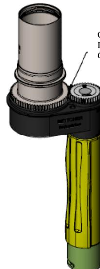
CERTIFIQUE-SE QUE A BASE DA LÂMINA SE ENCAIXA ATÉ O FINAL COM OS DENTES DA ENGENHAGEM
